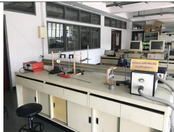
ชุดทดลองการเคลื่อนที่ของวัตถุ บนรางไร้แรงเสียดทาน
